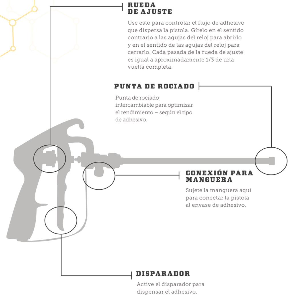
La Pistola para aplicaciones anchas ha sido diseñada para aplicar el adhesivo en grandes superficies. La varilla larga elimina la necesidad de que los usuarios se inclinen o arrodillen mientras aplican el adhesivo, eliminando de esa manera la tensión en la espalda y las rodillas y permitiendo una cómoda experiencia durante la aplicación del adhesivo.
